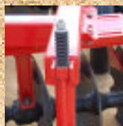
Regulación que permite mantener horizontal y nivelado el equipo de acuerdo a la altura de los enganches de las diversas marcas de tractores.
