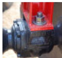
Cojinetes con rodamiento en baño de aceite que asegura la durabilidad y el buen desempeño del equipo.
