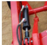
Cilindro hidráulico: permite regular la profundidad de trabajo desde el control remoto del tractor.
