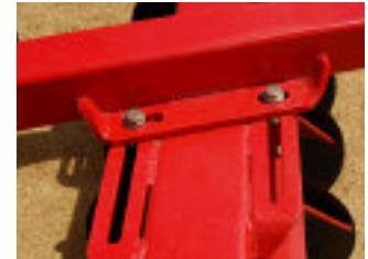
Las correderas extensivas en los paquetes de discos permiten una amplia regulación de los mismos mejorando notablemente el transito del equipo en trabajo.
